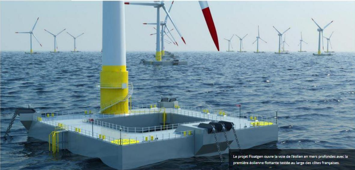
Le projet Floatgen ouvre la voie de l'éolien en mers profondes avec la première éolienne flottante testée au large des côtes françaises.
